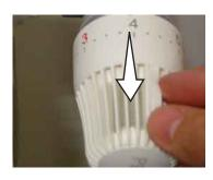
» Los topes móviles se retiran deslizándolos por su ranura, tomándolos por su extremo saliente. Si se encuentran cerca de la flecha indicadora de la escala, puede ser necesario mover levemente el cabezal para facilitar esta operación.
