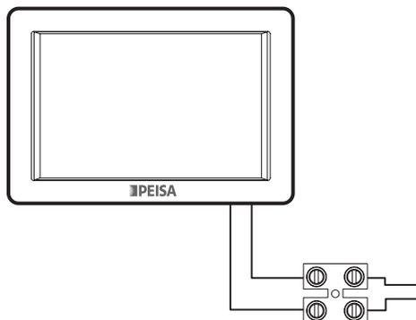
Para la conexión eléctrica del termostato de ambiente es necesario quitar el puente eléctrico en la bornera prevista en el interior de la caldera y conectar allí los cables provenientes del termostato. Se accede a dicha bornera retirando el techo de la caldera.
