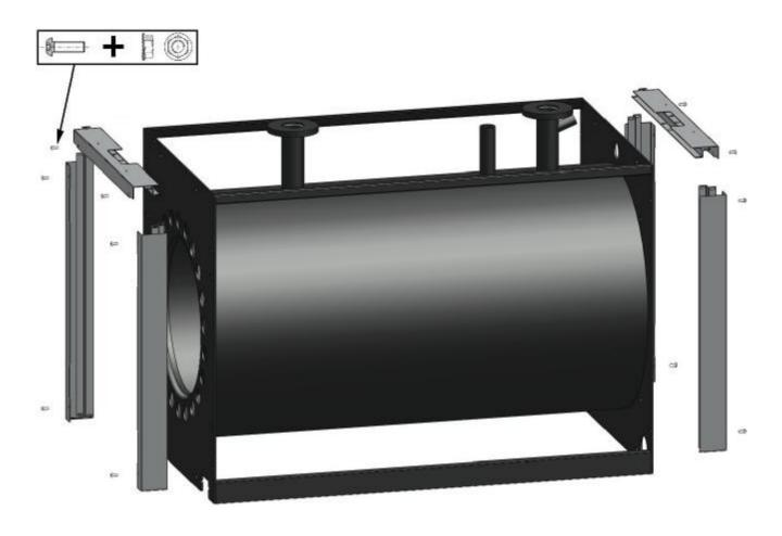
4) Introduzca los paneles rojos, con los accesorios plásticos previamente colocados, entre los travesaños superiores y verticales, según muestra la figura:
