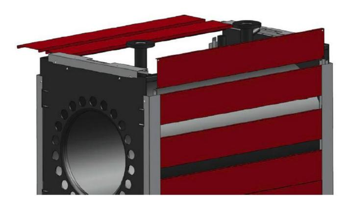
5) Luego de haber colocado todos los paneles, instale los cobertores utilizando los tornillos provistos indicados en la figura:
