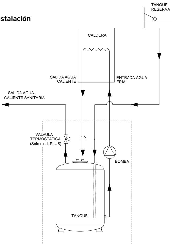
Cuando el termostato del Boiler solicita calentamiento del agua, se pone en funcionamiento la bomba del mismo, lo que habilita la circulación del agua del tanque a través de la caldera, encendiendo el quemador de la misma para obtener agua caliente sanitaria.
