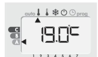
**Modo ECO:** El radiador opera a 3.5 °C por debajo de la temperatura establecida en el modo COMFORT (por ej.: 15.5 °C).
